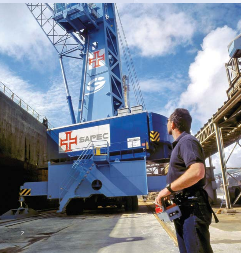
Verfahren und Steuern eines HMK 170 EG via Funkfernsteuerung auf einem engen Kai bei SAPEC, Portugal
