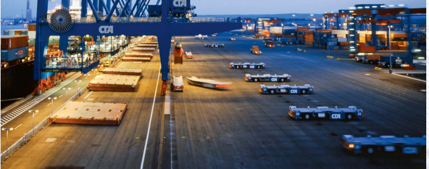
Gottwald Geräte wie AGV Automated Guided Vehicles sind Bestandteil integrierter Umschlaglösungen und führen zur Leistungssteigerung von Terminals sowie zur Optimierung der Logistikkette
