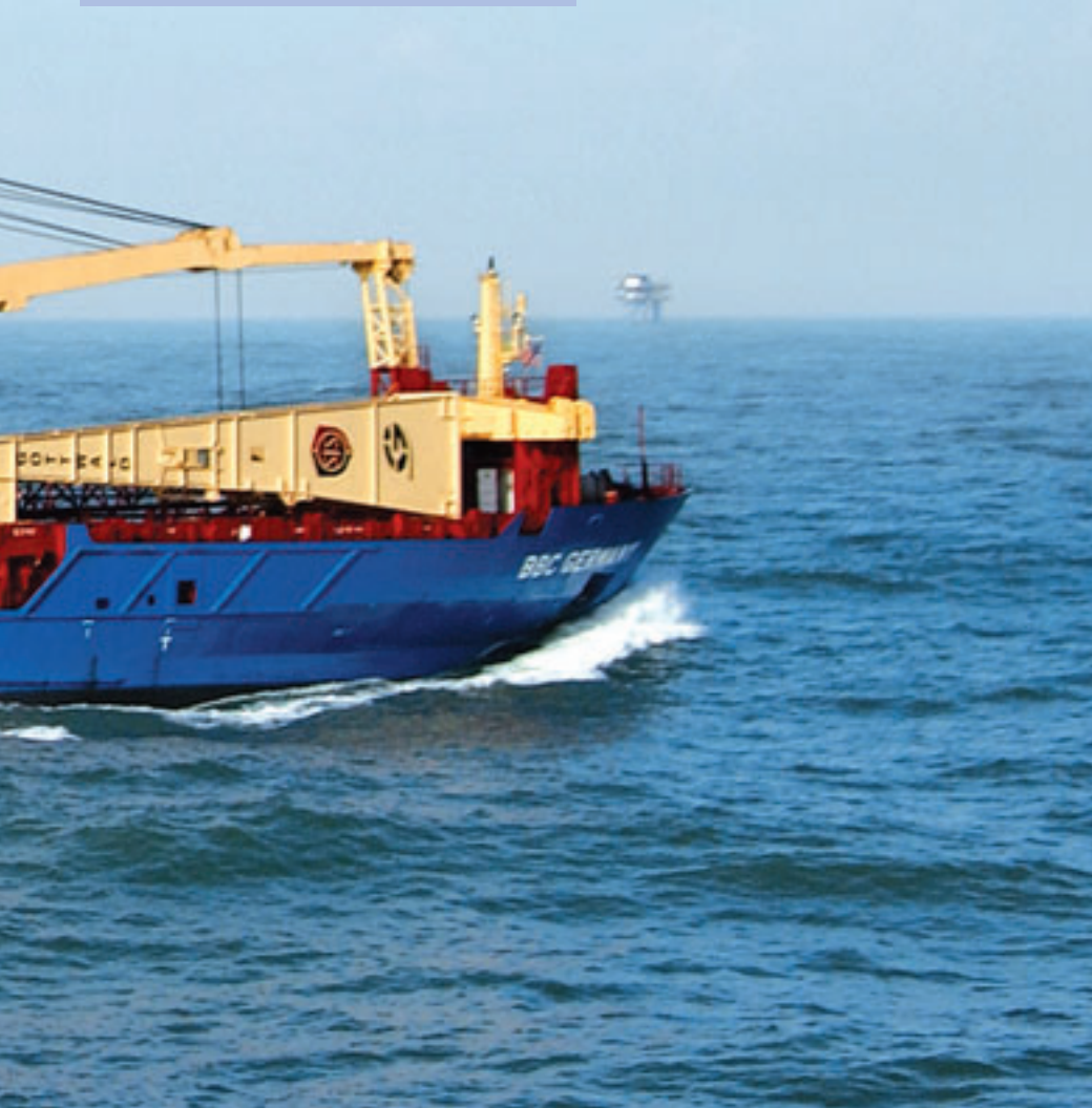
Verschiffung vormontierter Baugruppen eines Gottwald Krans via Binnenschiff
