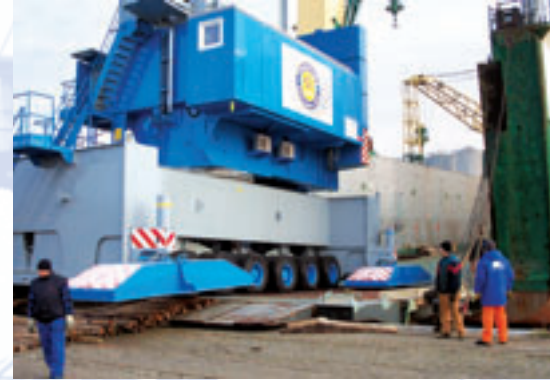
Einfahrt des Krans in ein Ro-Ro-Schiff
