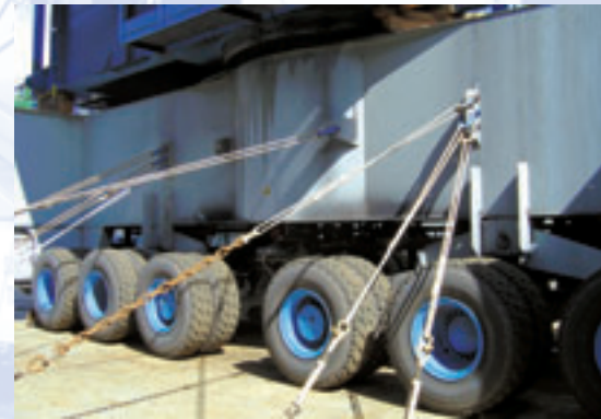
Verzurrter Gottwald Kran für höchste Stabilität und Sicherheit während des Transports
