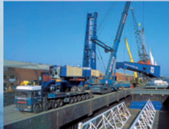
Verschiffung vormontierter Baugruppen eines Gottwald Krans via Binnenschiff
