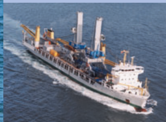
Transport von zwei komplett montierten Gottwald Kranen mittels Schwerlastschiff
