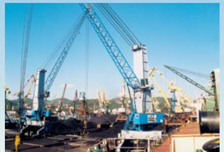
Zwei Hafenschienenkrane HSK 170 EG beim Umschlag von Kohle und Stahl im Hafen von Tuapse, Russland
