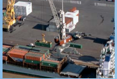
Hafenschienenkrane HSK 260 EG beim Containerumschlag ...
