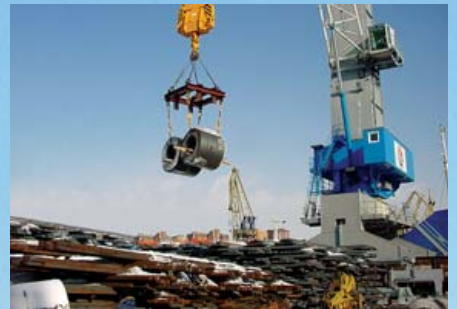
Hafenschienenkran HSK 170 EG beim Umschlag von Stahl-Coils im Hafen von Wladiwostok, Russland
