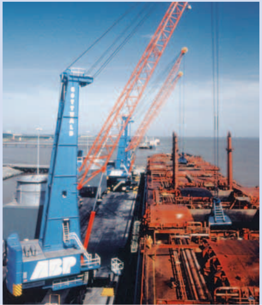
HMK 280 EG Hafemobilkrane bei ABP in Immingham, Großbritannien – zur Versorgung von Kraftwerken werden hier jährlich über 6 Millionen Tonnen Steinkohle umgeschlagen
