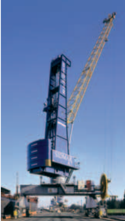
HSK 300 E mit kundenspezifischem Portal – vom Drehkranz an aufwärts werden die bewährten Baugruppen des Hafemobilkrans eingesetzt
