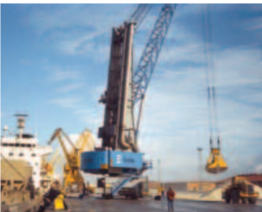
HMK 300 EG mit aktivem Staubschutzsystem bei Ership, Huelva, Spanien
