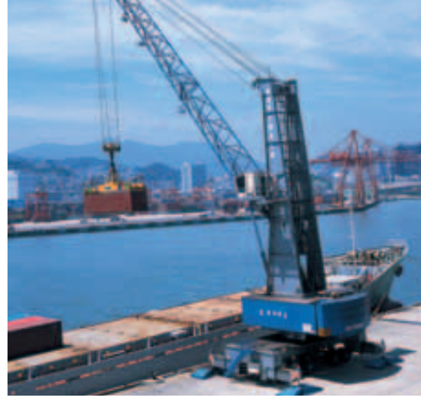
Ausgestattet mit unterschiedlichen Anschlagmitteln, schlagen Gottwald Hafenkranne in 2-Seilausführung alle Güterarten um
