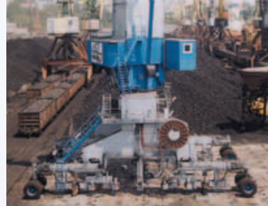
HSK 170 EG, ausgestattet mit speziellen Verfahreinrichtungen und 8 Abstützplatten
