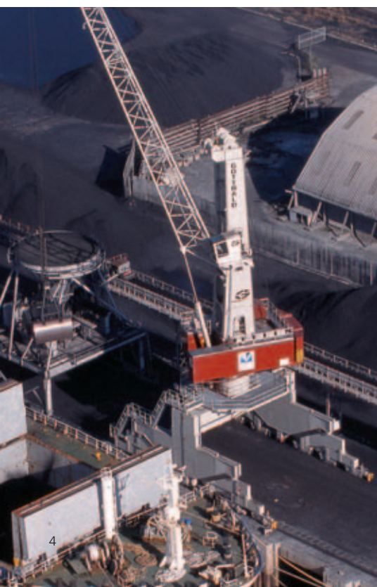
Grue mobile sur rails HSK 260 EG manutentionnant du charbon à Bordeaux, France
