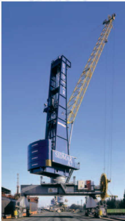
HSK 300 E avec un portique réalisé selon les spécifications du client. La machine reprend les ensembles éprouvés des grues mobiles portuaires, de la couronne d'orientation au sommet de la grue.
