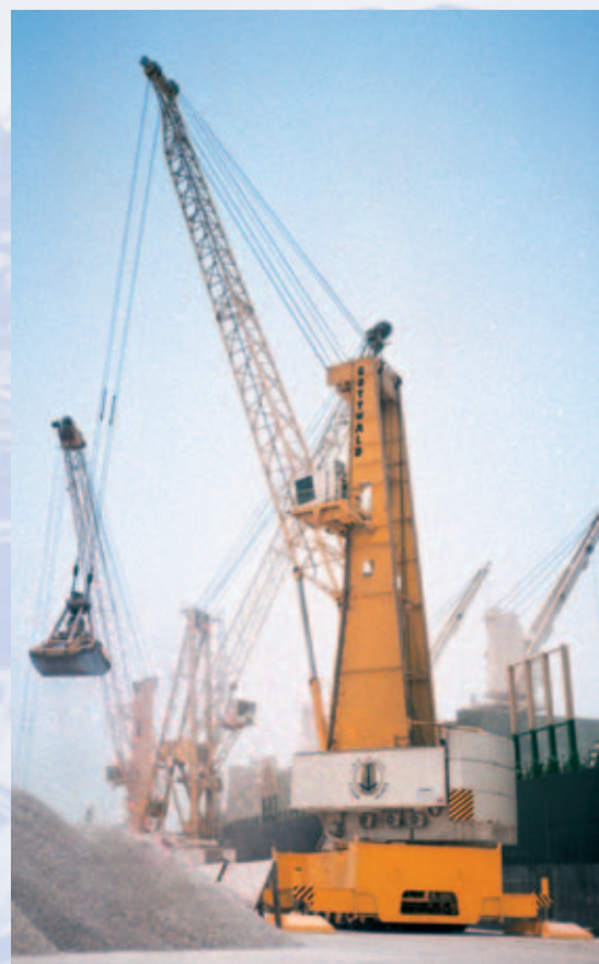
HMK 330 EG lors de la manutention de clinker chez Saqr Port Authority Mina Saqr, à Ras al Khaimah, Emirats Arabes Unis
