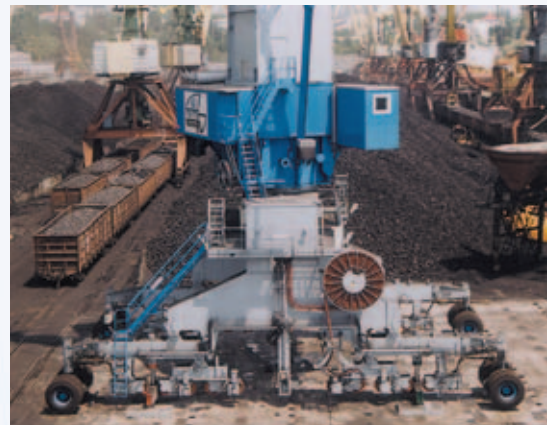
HSK 170 EG, équipée d'une installation de translation spéciale et de 8 patins de calage
