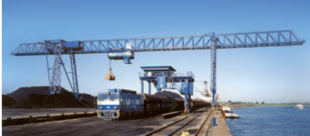
Portique intermodal WSG lors de la manutention intermodale entre voie d'eau et rail à Orsoy, Allemagne
