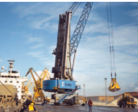
HMK 300 EG avec un système de protection actif contre la poussière chez Ership à Huelva, Espagne
