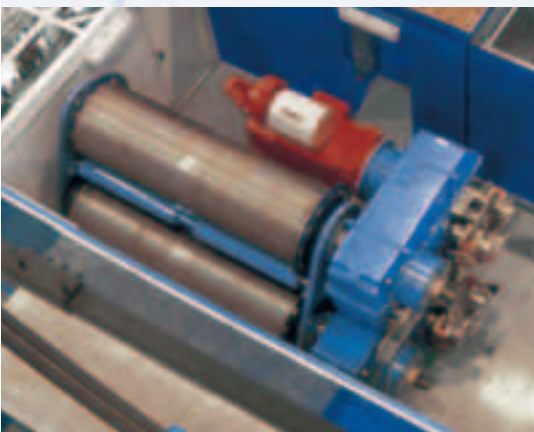
Dois mecanismos de elevação numa grua com balde de quatro cabos da Gottwald
