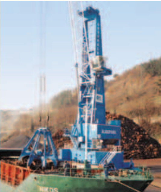
Grua portuária móvel HMK 300 EG em actividades de carga e descarga de sucata em Pasajes, Espanha
