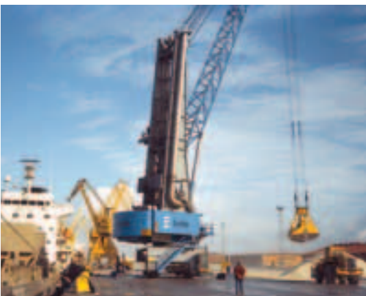
HMK 300 EG com sistema activo de protecção contra o pó em Ership, Huelva, Espanha
