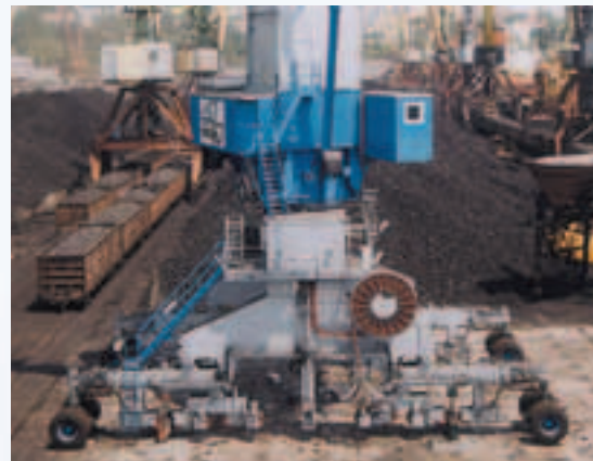
HSK 170 EG, equipada com unidades de translação especiais e 8 sapatas de estabilização
