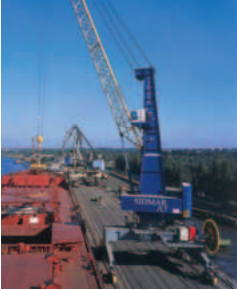
Quando equipadas com os mais variados acessórios de engate, as gruas portuárias de dois cabos da Gottwald ficam preparadas para todo o tipo de cargas
