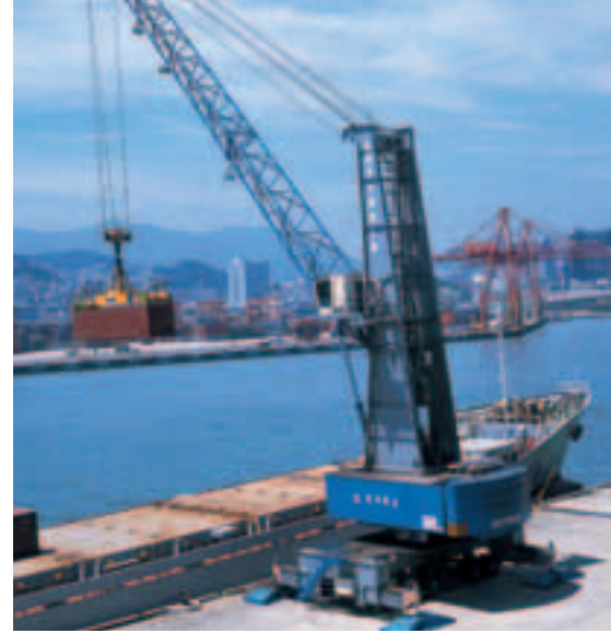
Quando equipadas com os mais variados acessórios de engate, as gruas portuárias de dois cabos da Gottwald ficam preparadas para todo o tipo de cargas
