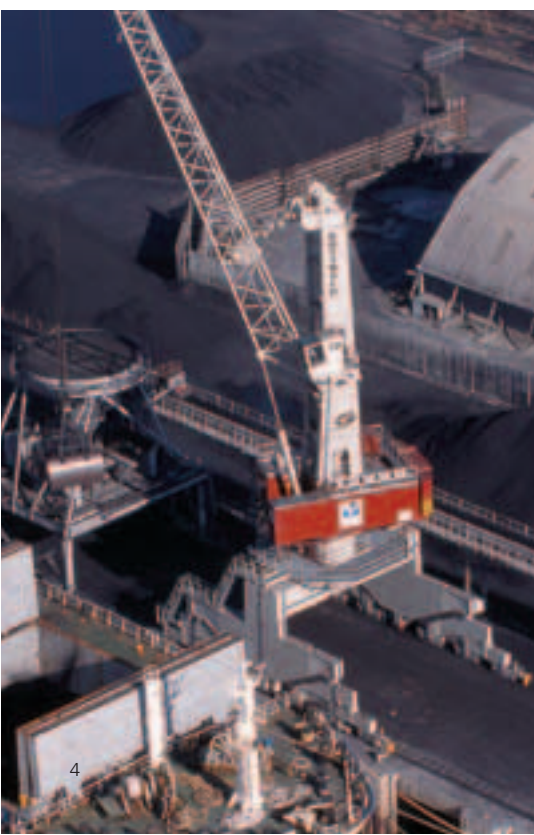
Grua portuária sobre carris HSK 260 EG em actividades de carga e descarga de carvão em Bordéus, França
