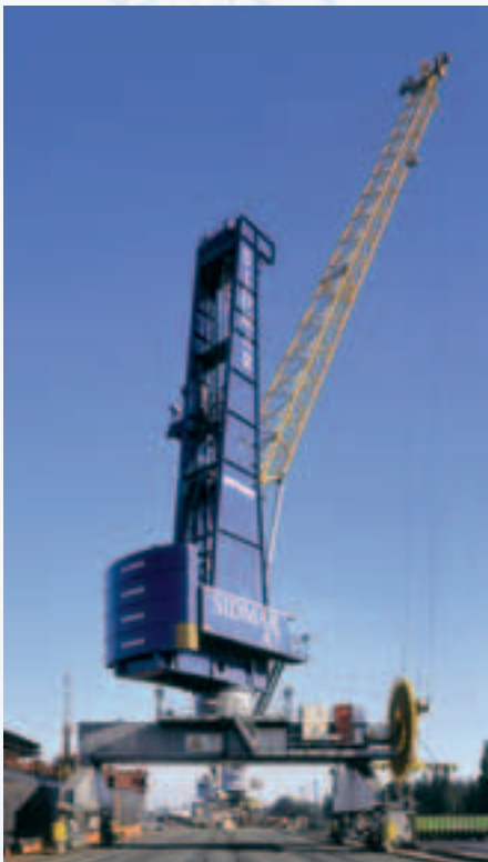
HSK 300 E com pórtico personalizado para o cliente – da coroa rotativa para cima, as HSK usam os mesmos módulos que a grua portuária móvel
