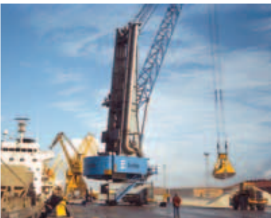
HMK 300 EG con sistema de protección contra el polvo activo en Ership, Huelva, España
