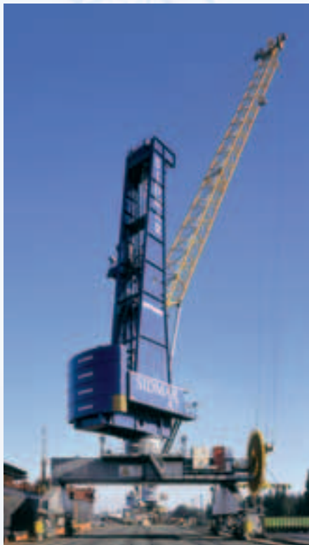
HSK 300 E con pórtico diseñado según los requisitos específicos del cliente – de la corona giratoria hacia arriba se utilizan los acreditados componentes de la grúa móvil de puerto
