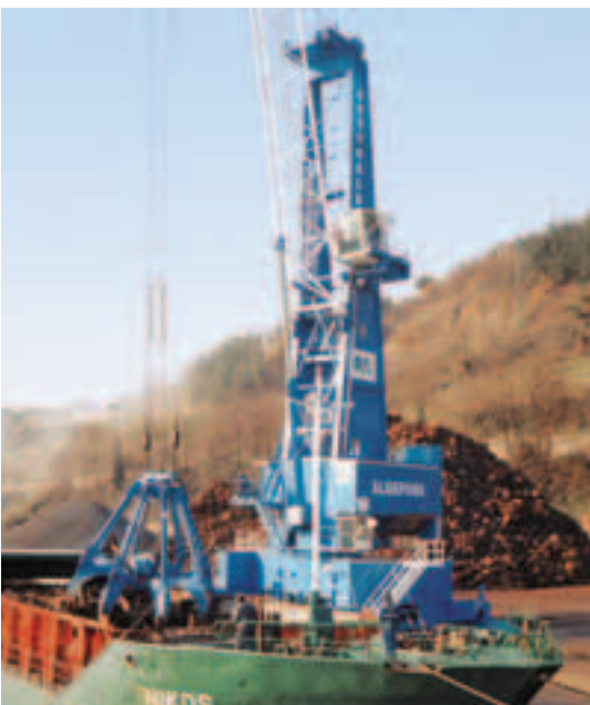
Grúa móvil de puerto HMK 300 EG durante la descarga de chatarra en Pasajes, España
